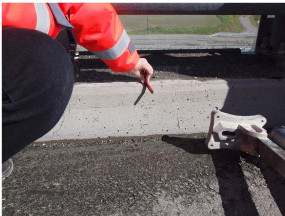
Rosvollbrua: Prøver tatt mellom armeringsjern ca 90 mm fra topp og ca 40 mm fra veidekket
