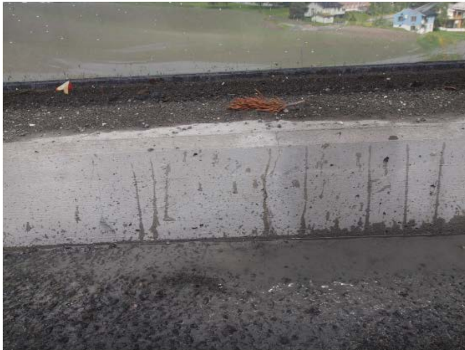
Rosvollbrua: Påført vann på overflate på prøvelfelt mellom stolpe 6 og 7 (StoCryl HG300) som viser at overflaten er litt vannavstøtende.
