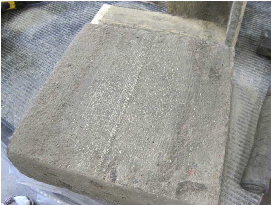
Figur 4. Utseende på avformad provkropp tillverkad av betong med v_{ct}=0,70 . Skador orsakade av betong som har fastnat i träformen syns vid ränderna på formen.
