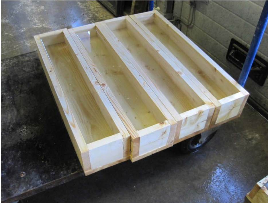
Figur 1. Balkformar (ca 600 \times 100 \times 100 \text{ mm}^3 ) som har använts för att tillverka kuber (ca 100 \times 100 \times 100 \text{ mm}^3 ). Kuberna sågas ut från balkformarna (6 kuber per form). Formarna är fyllda med vatten inför gjutning.
