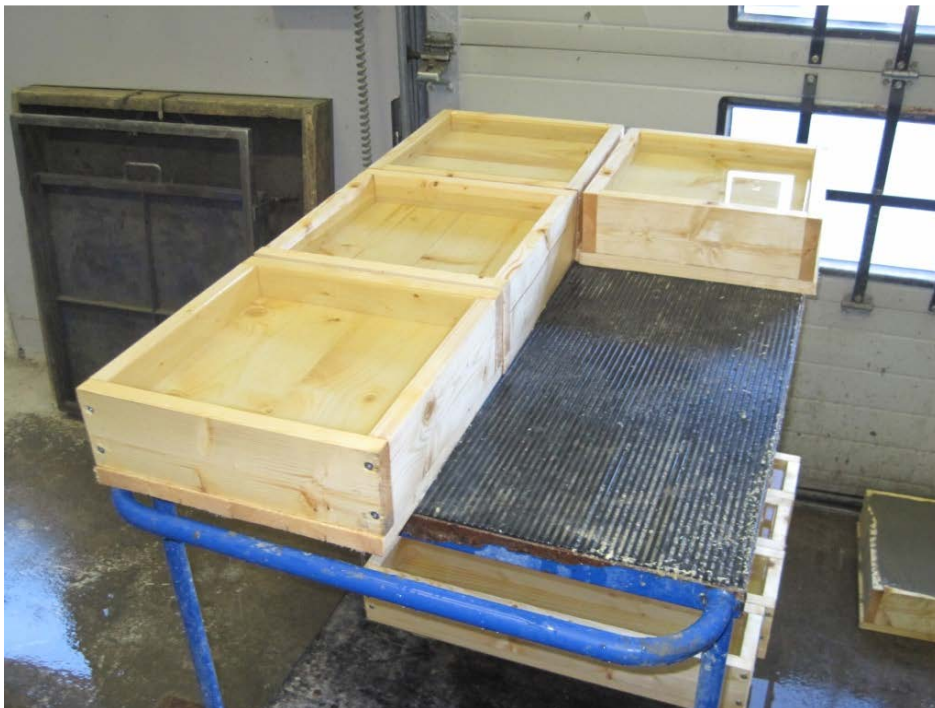
Figur 2. Plattformar (ca 300 \times 300 \times 100 \text{ mm}^3 ) som har använts för att tillverka plattor. Formarna är fyllda med vatten inför gjutning.
